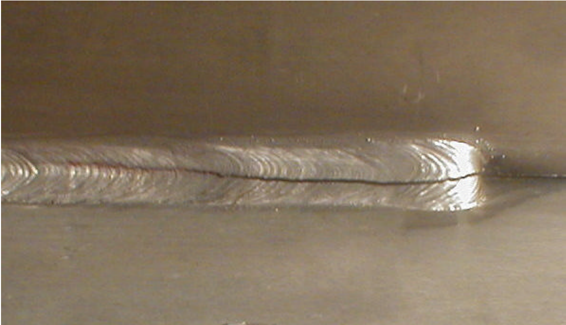
Figure 5 Revneudbredelse i kantsøm uden kraterrevne
