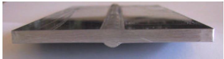
Fig.: 3b Tværsnit af sømform i 5083 serie
