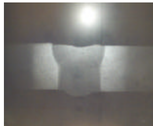
5mm AA5083 Lasersvejsning 1000mm/min
