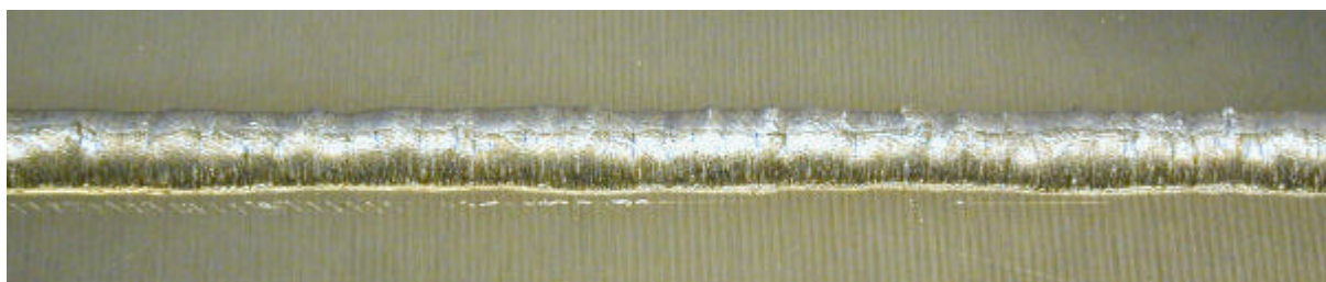
Figur 4.3 Rodside SH1.12 Svejsehastighed 1000 mm/min, samlet heat-input 311 J/mm. Energifordeling: Laser 58%, MIG 42%
