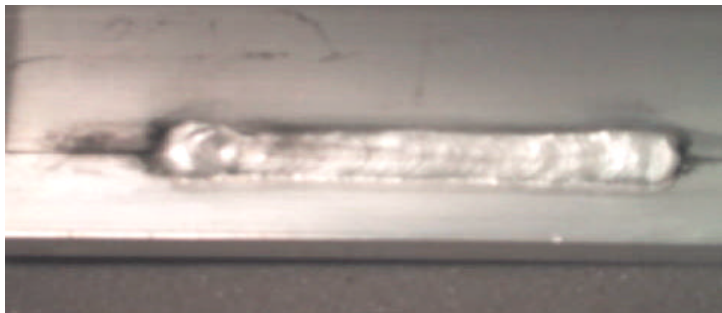
Fig.: 1 MIG-svejsning med start samt tilbageføring i stopsekvens
