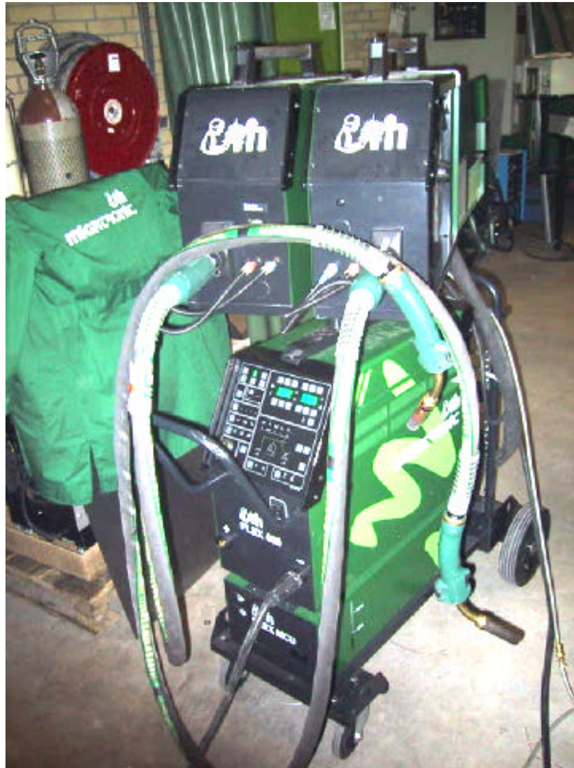
Figur 4: Svejsemaskine med dobbelt trådboks
