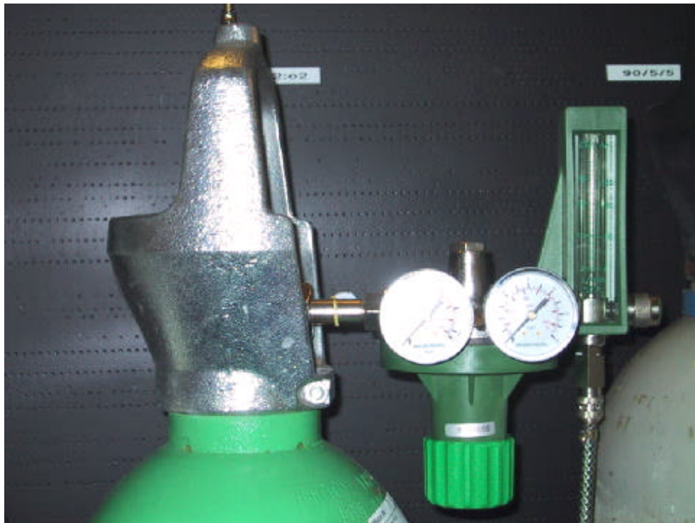
Figur 5: Reduktionsventil med flowmeter
