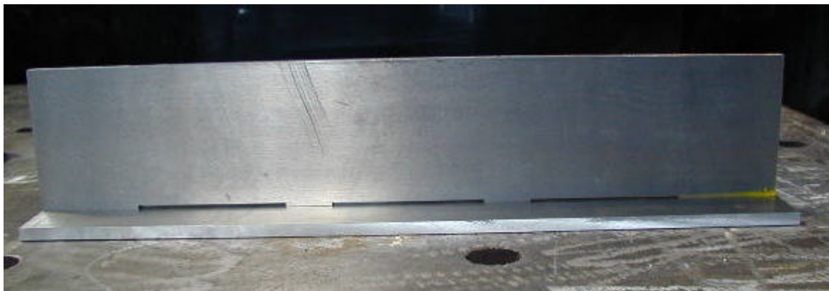
Figur 2.1 Forsøgsemne med 3 forskellige udfræsninger på kropspladen og således 3 forskellige størrelser fugespalte.
