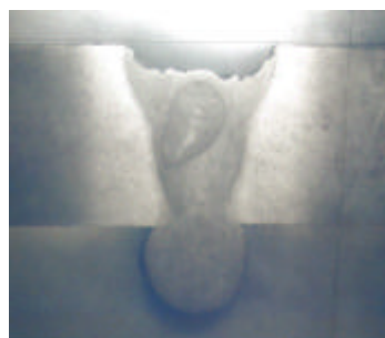
3,75 kW, 1500 mm/min trådshastighed 3000 mm/min
