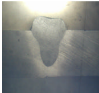
3,75 kW, 2000 mm/min trådshastighed 3000 mm/min
