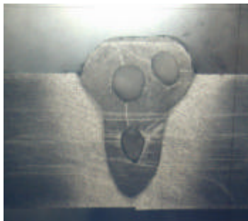
3,5 kW, 1500 mm/min trådshastighed 3000 mm/min
