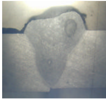
3,5 kW, 1000 mm/min trådshastighed 4000 mm/min
