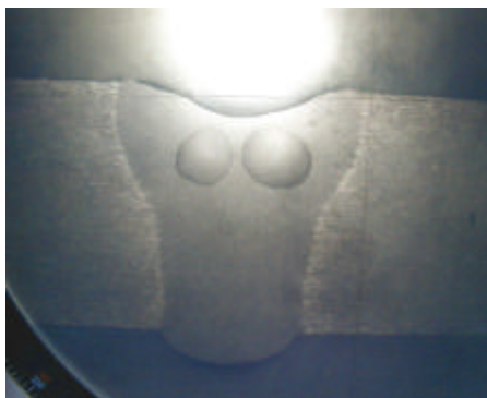
Figur 4.15 svejsning af 8mm AA5083 (4,0 kW, 400 mm/min)
