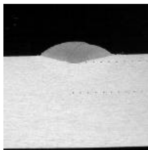
Forsøg: M12 v = 400 mm/min U = 26,4 V I = 125 A
