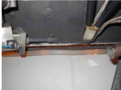
Figur 5.8: Fugfølger + brænder på aluminien
