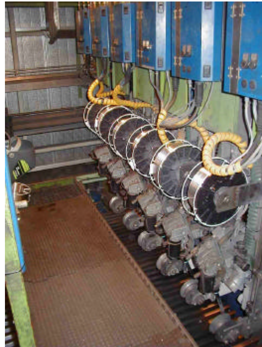
Figur 5.4: Trådrulle – trådmotor - brænder
