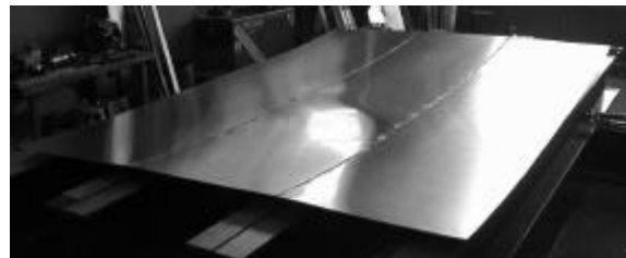
Figur 1. Svejste plader med spræld, der efterfølgende blev rettet op ved hamring.
